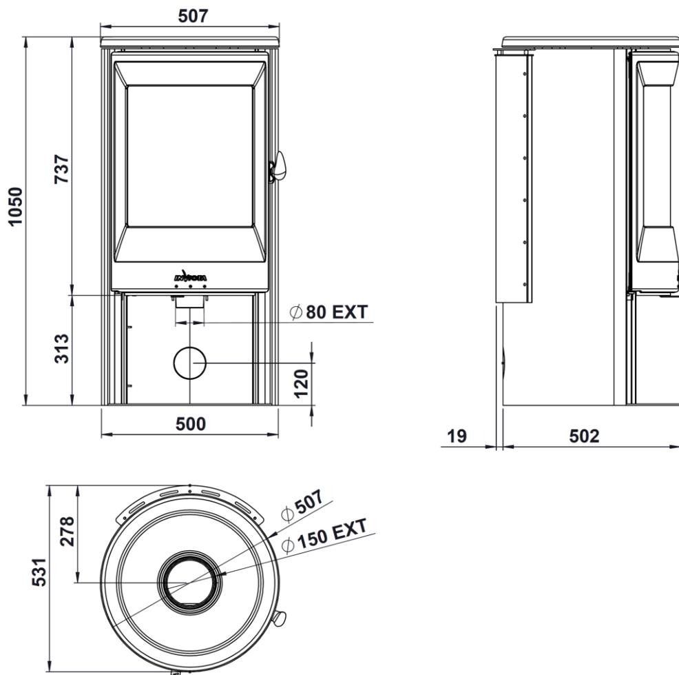
Figure n°1 - Dimensions en mm de l'appareil NEOSEN
