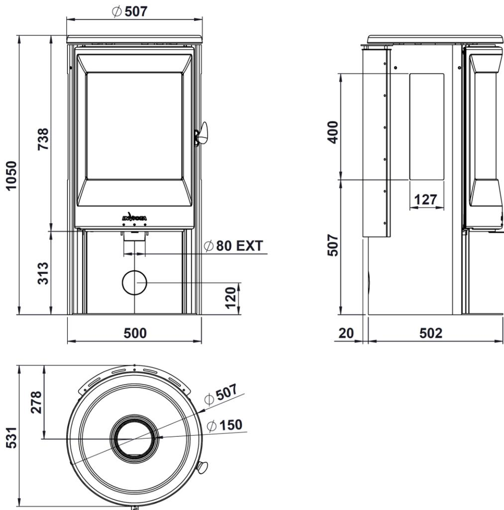
Figure n°2 - Dimensions en mm de l'appareil NEOSEN 3V
